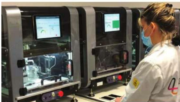
Les robots installés par Largo permettent d'automatiser l'inspection de 37 points de contrôle d'un smartphone.
